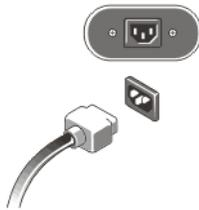
**Abbildung 6. Anschließen der Stromversorgung**
